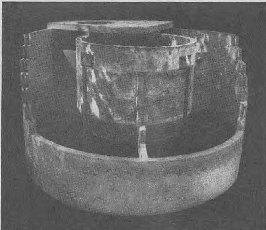
Kleinbelebungsanlage der Firma Noack / Caputh (Demonstrationsmodell)
