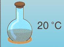
Die Probe wird verschlossen und bei 20 °C thermostatisiert. Die Bakterien bauen einen Teil der organischen Wasserinhaltsstoffe unter Sauerstoffverbrauch ab.
