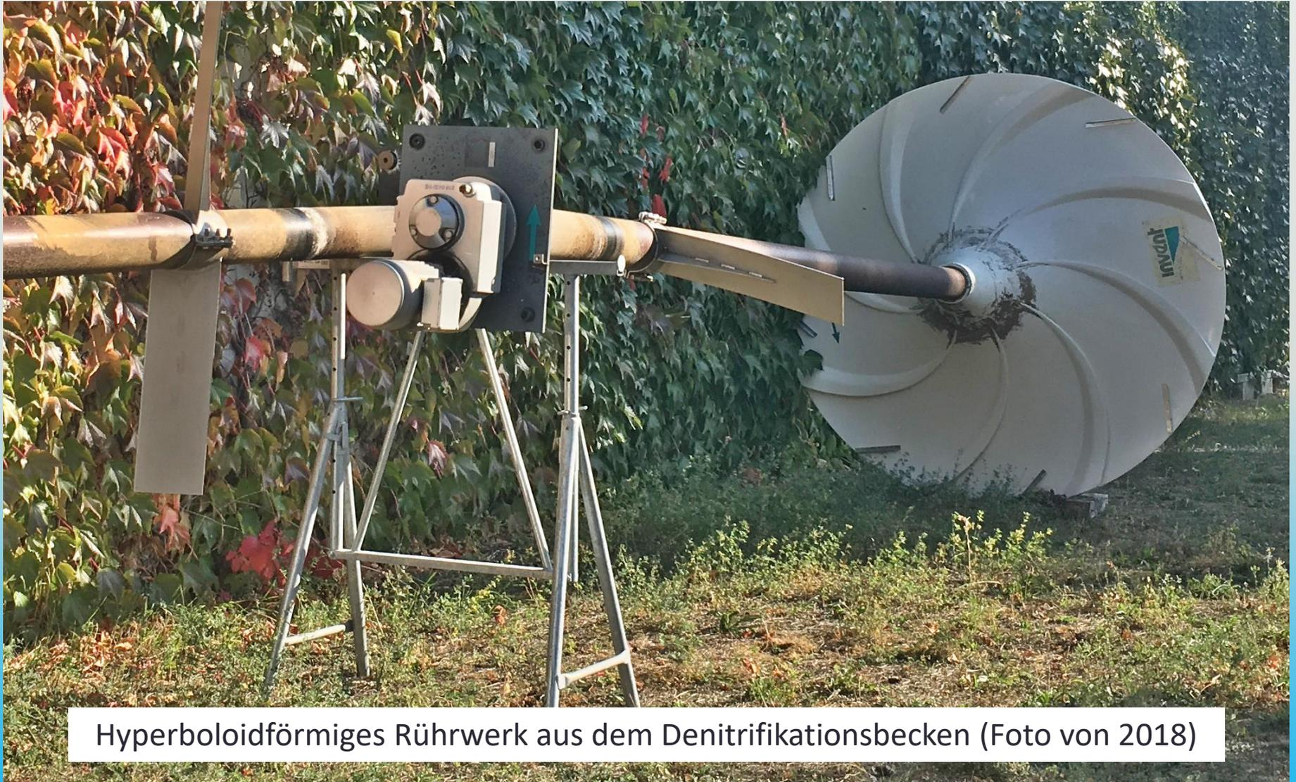
Hyperboloidförmiges Rührwerk aus dem Denitrifikationsbecken (Foto von 2018)
